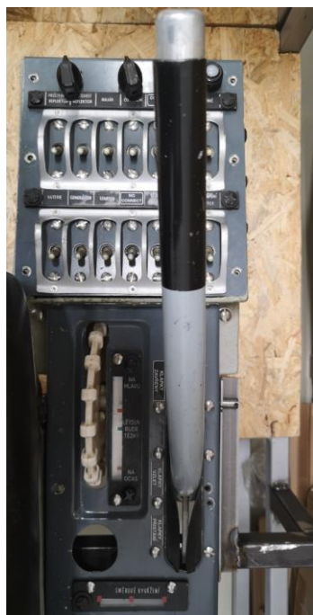
Obrázok 9: Mechanizmus ovládania vztlakových klapiek a ovládania vyváženia umiestneného na simulátore Zlín.
