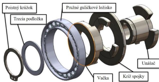
Obr. 2. Zostava generátora vln harmonického prevodu
