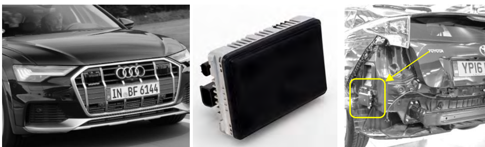
Obr. 30. Orientačné umiestnenie radarov na Audi A6 2020 (vľavo). Náhľad na Long range radar od firmy Continental (v strede). Short range radar po demontovaní nárazníku (vpravo). [19] [31]
