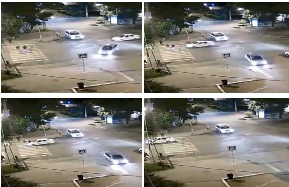
Obr. 34. Začiatok reakcie vodiča (vľavo hore). Začiatok brzdenia vodiča (vpravo hore). Zrážka s chodcami (vľavo dole). Konečná poloha vozidla (vpravo dole). [14]
