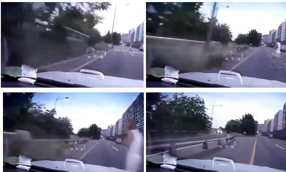
Obr. 36. Chodec prichádza sprava (vľavo hore). Chodec vstupuje do koridoru jazdy vozidla (vpravo hore). Vodič mierne vyhýba a zráža chodca (vľavo dole). Vozidlo stojí v konečnej polohe (vpravo dole). [14]
