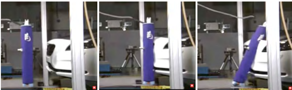
Obr. 98. Voľný let rýchlosť (vľavo). Prvý kontakt s vozidlom (v strede). Maximálne sily pôsobiace na impaktor (vpravo) [61]
